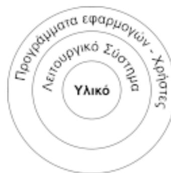
Σχήμα 7.2 Επίπεδα ενός συστήματος υπολογιστή
