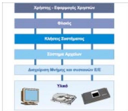
Σχήμα 7.3 Στρωματοποιημένη δομή ΛΣ
